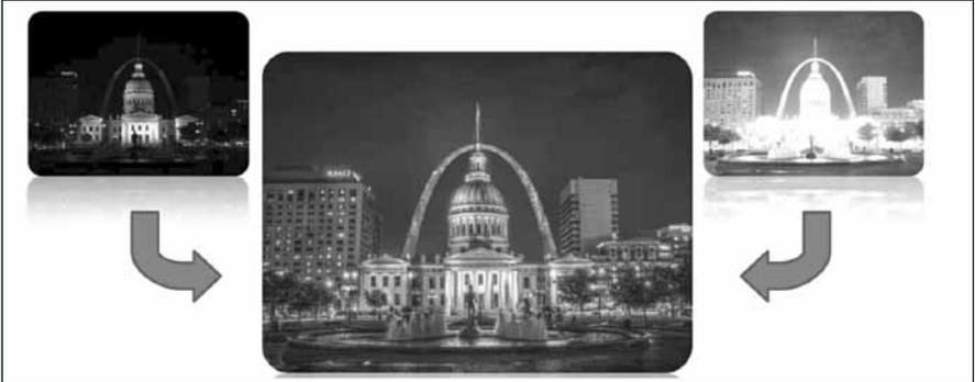
図-10 露光時間の異なる画像を合成したHDR写真の例
