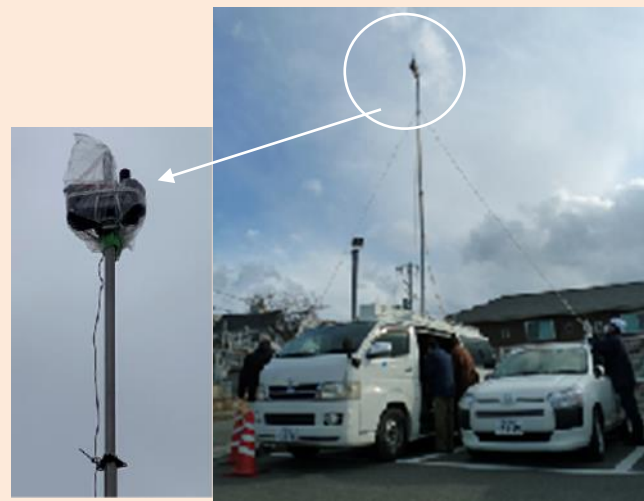
電測車（ポールに受信機設置、ポール高：8m）
